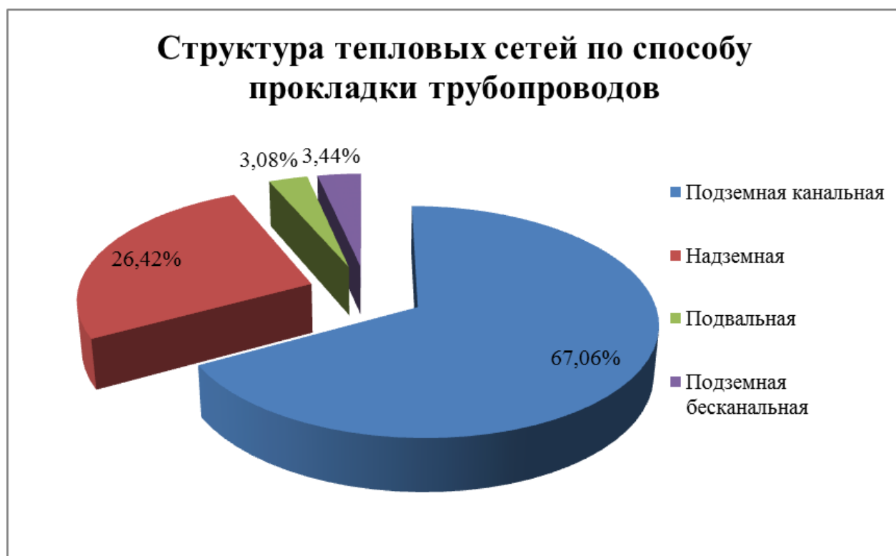
Рисунок 9. Структура тепловых сетей с разбивкой по способу прокладки
