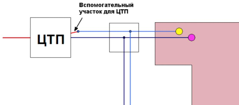
**Рисунок 9. Подключение трубопровода ГВС**
