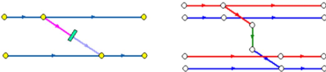
**Рисунок 17. Соединение между подающим трубопроводом одного участка и обратным трубопроводом другого участка**
