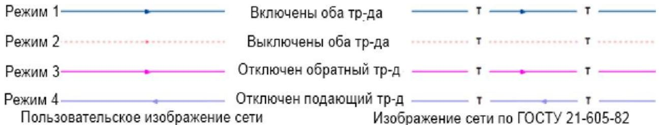
**Рисунок 6. Изображение нескольких состояний участков, задаваемых различными режимами**
