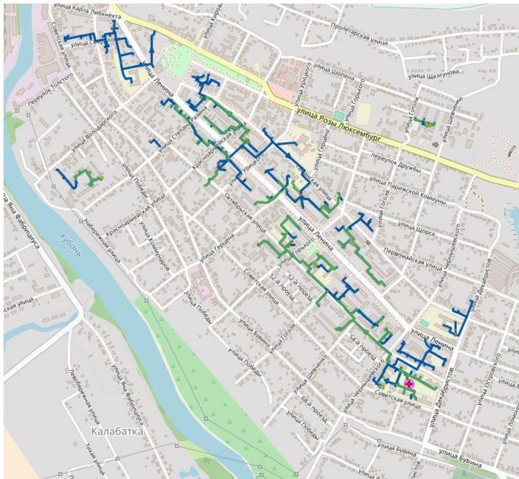
**Рисунок 4. Изображение тепловой сети на карте с привязкой к местности**
