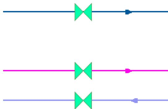
**Рисунок 14. Однолинейное и внутреннее представление задвижки**
